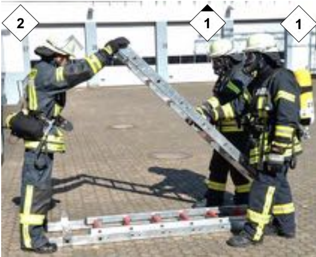
Abbildung 32: Aufklappen der Multifunktionsleiter
