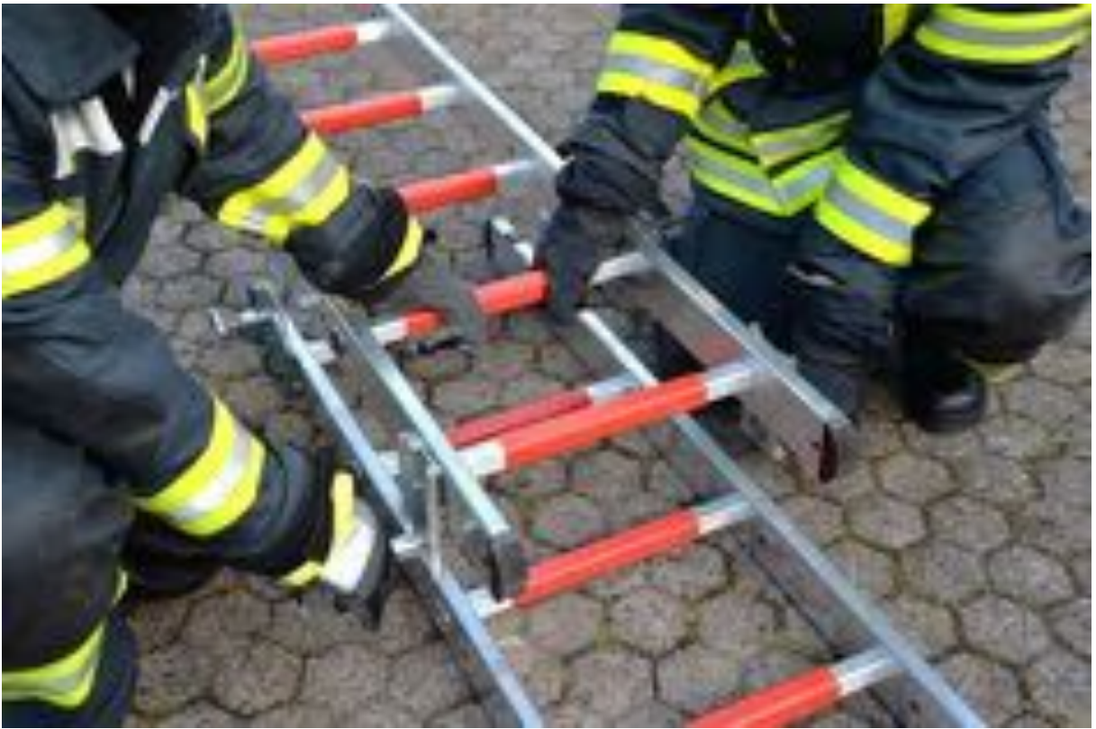
Abbildung 40: Ausrichten der Federbolzen
