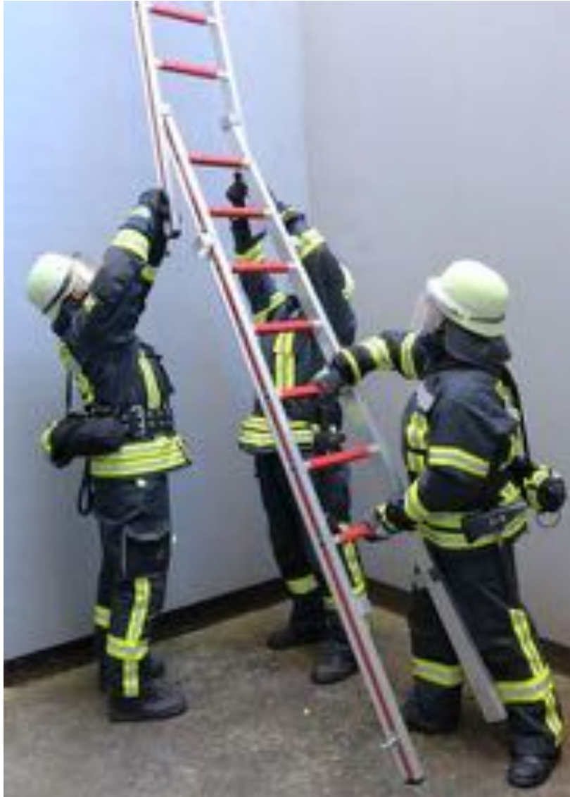
Abbildung 16: Einstecken eines Leiterteils am Leiterfuß
