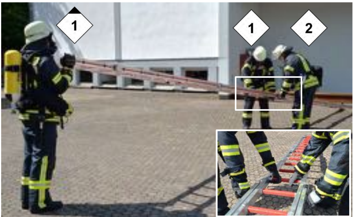
Abbildung 6: Zusammenstecken der Steckleiterteile
