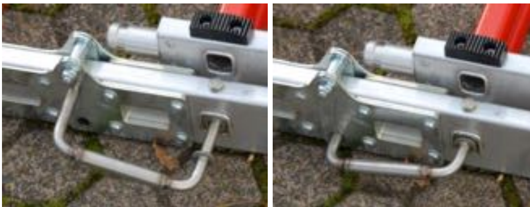
Abbildung 33: Arretieren der Scharnierverschlüsse
