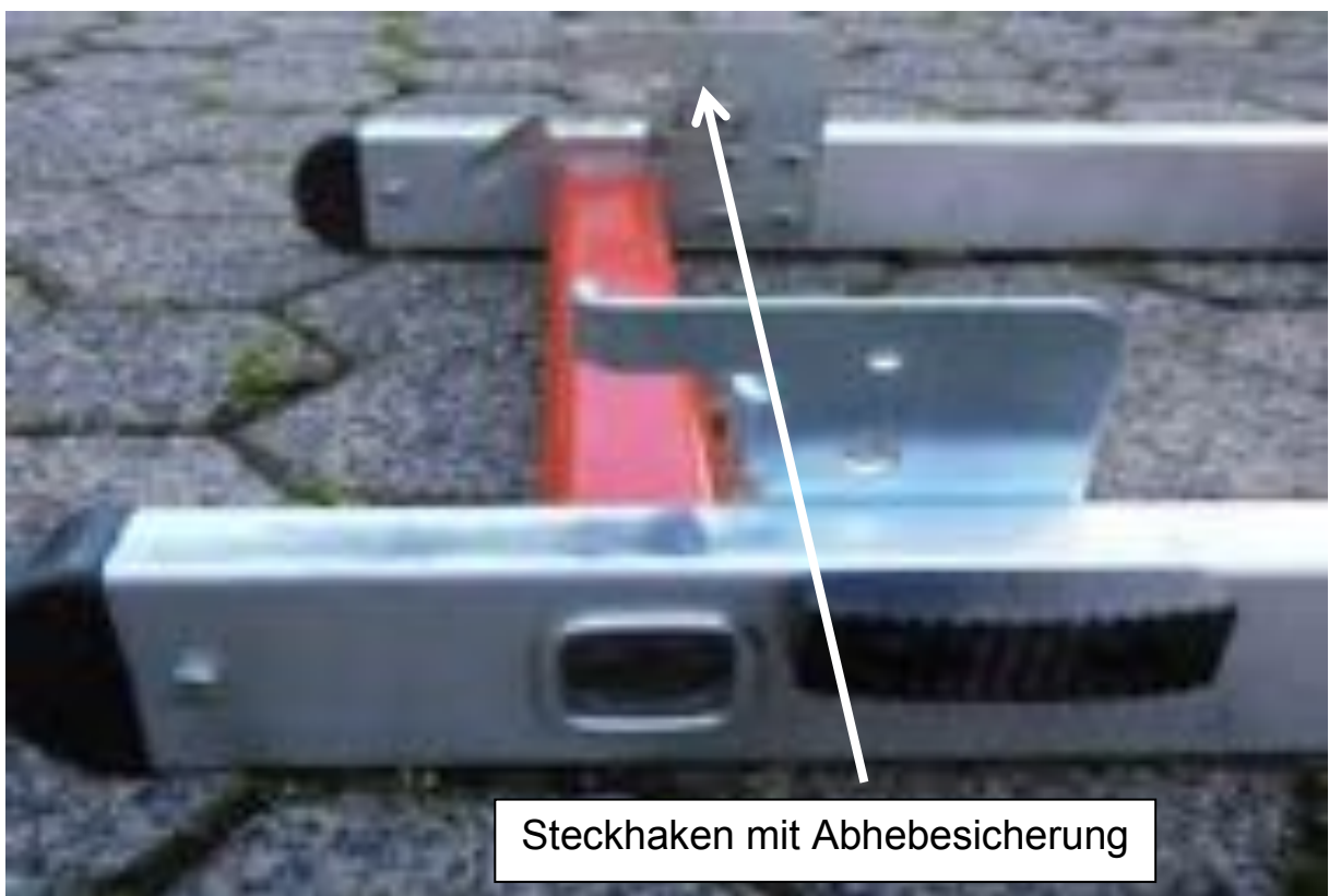
Abbildung 30: Aufsteckteil der Multifunktionsleiter
