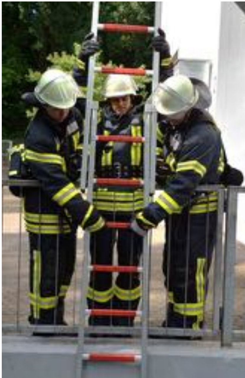
Abbildung 18: Aufstecken eines Leiterteils
