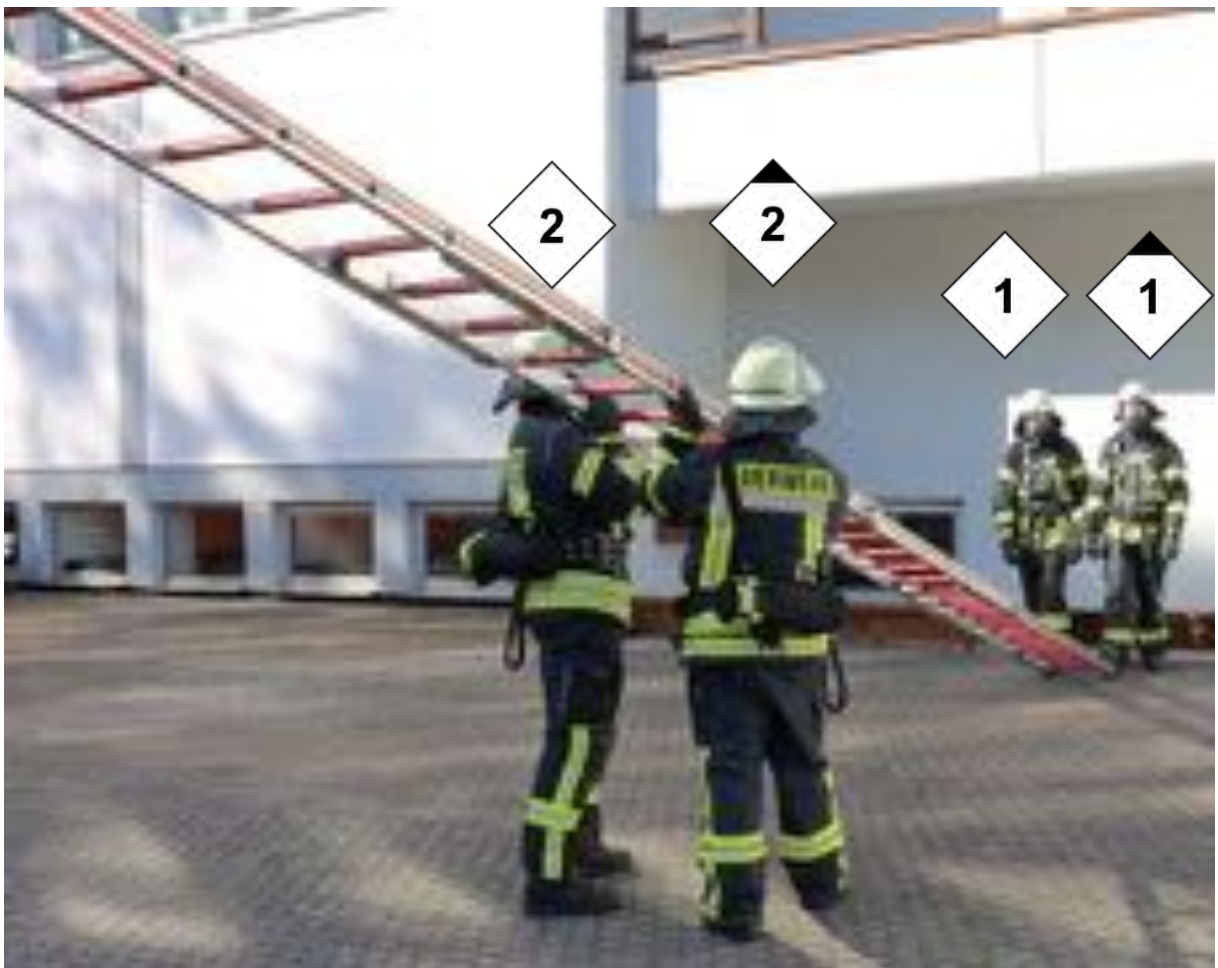
Abbildung 14: Aufrichten der Steckleiter
