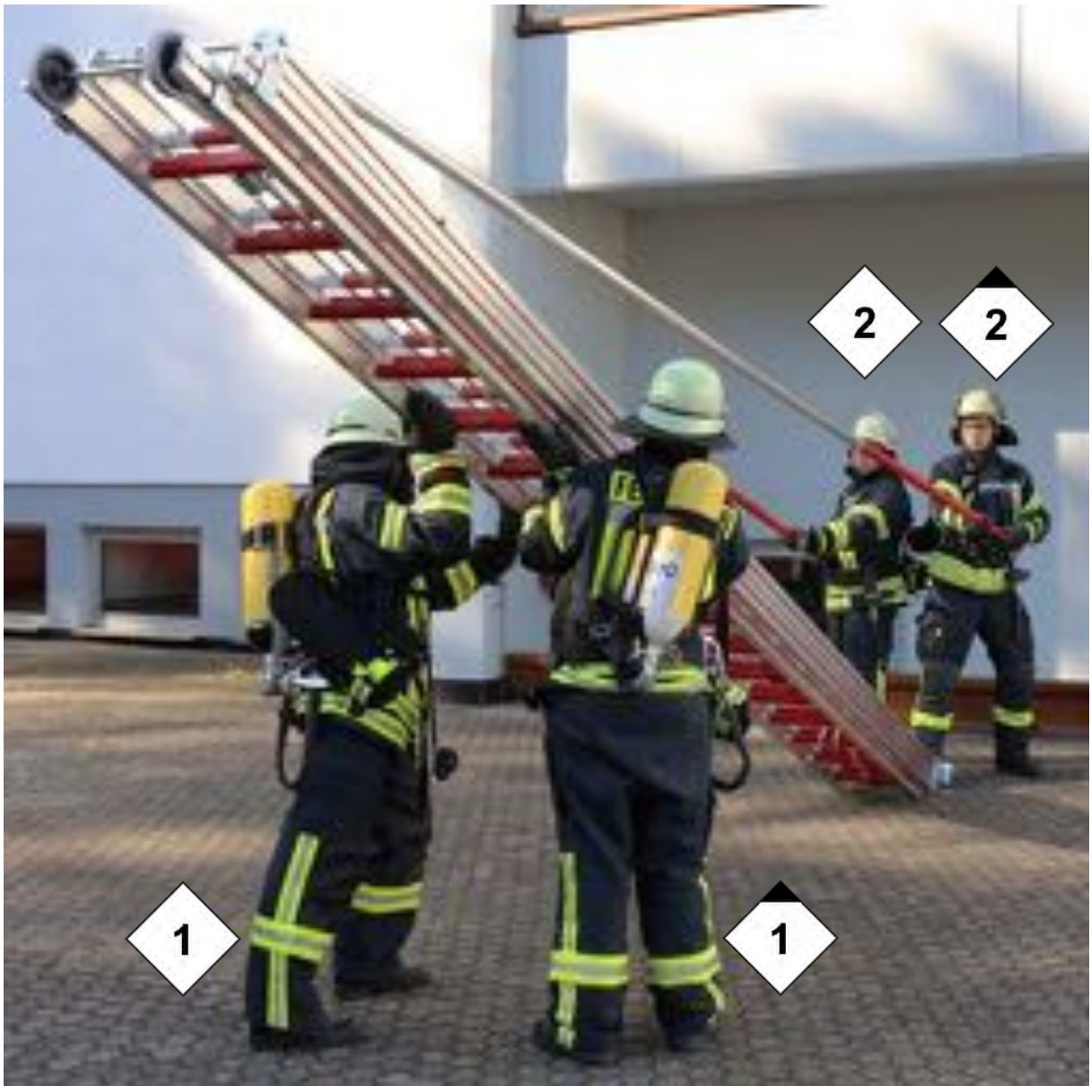
Abbildung 22: Aufrichten der Schiebleiter
