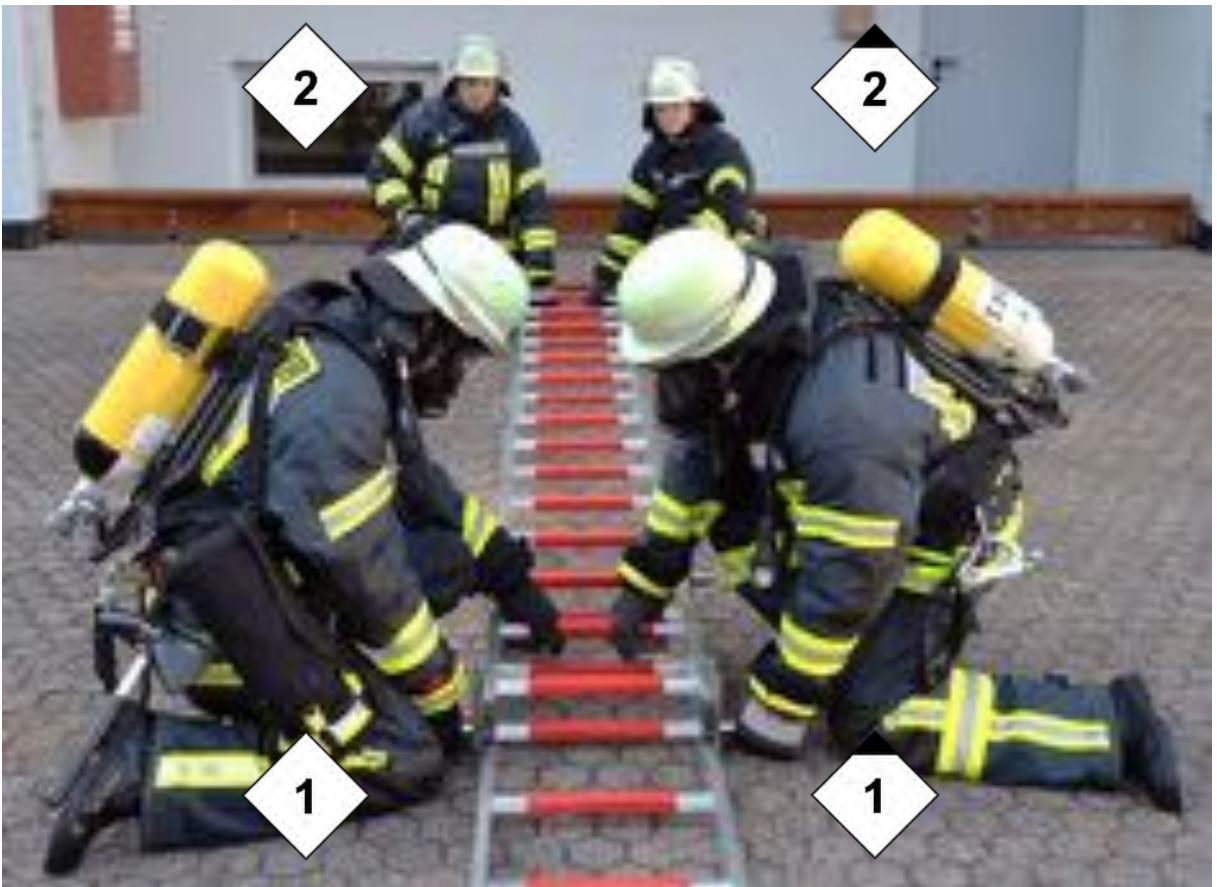
Abbildung 41: Verbinden der Multifunktionsleitern
