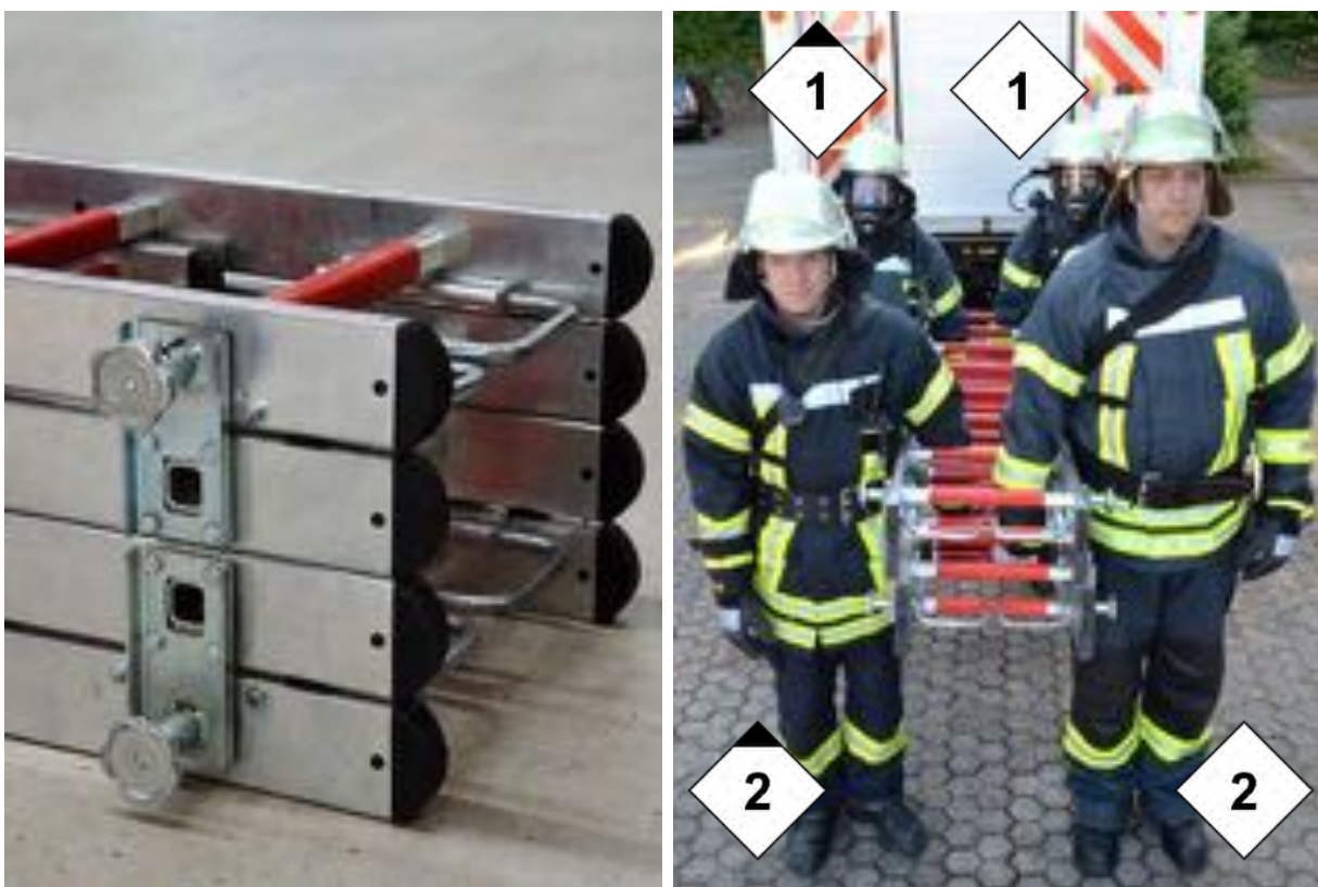
Abbildung 37: Trageweise der Multifunktionsleitern zur Anleiterstelle
