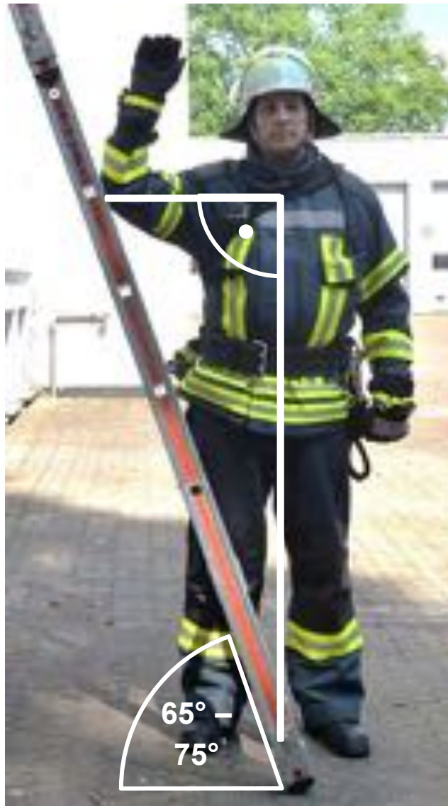
Abbildung 2: Überprüfen des Anstellwinkels
